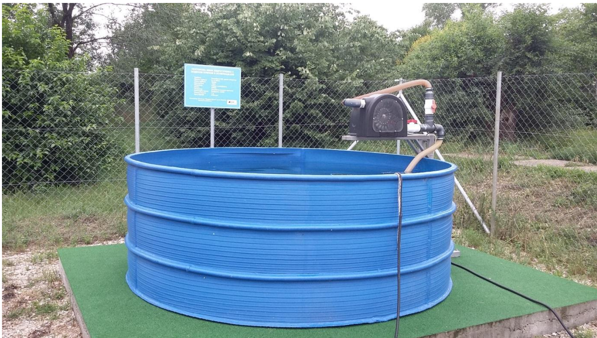
Слика 10. Хидротурбина са базеном и потапајућом воденом пумпом који симулирају водену акумулацију и водени ток који покреће турбину.
