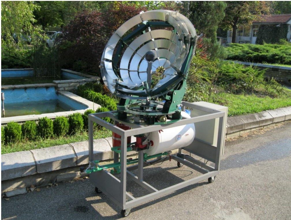
Слика 12. Лабораторијски прототип соларног концентратора енергије са бојлером за складиштење топлотне енергије [12]. Систем користи наизменични напон (из Мобилног аутоматизованог соларног електро-генератора приказаног на Сл. 1) за покретање циркулационе пумпе воденог кола (Сл. 4) и линеарног мотора за регулисање нагиба огледала.
